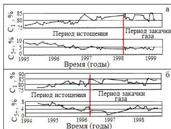
Рис. 2. Изменение компонентного состава газоконденсатного флюида в двух скважинах (K233-а и K243-б) месторождения Кекейя, Китай (Shi, 2009)
