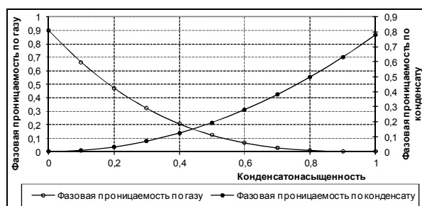
Рис. 1. Кривые фазовых проницаемостей
