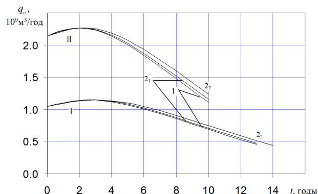
Рис. 5. Изменения дебита одной скважины во времени 1 – нелинейно-упругая среда; 2 1 – ползучая среда: m_1 = 3,4 \cdot 10^{-8} (МПа·сек) -1 ; 2 2 – ползучая среда: m_1 = 10,2 \cdot 10^{-8} (МПа·сек) -1 ; I – \Delta \bar{P} = 0,1 ; II – \Delta \bar{P} = 0,2
