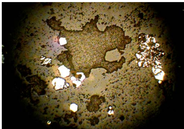
Рис. 1. Идиоморфные кристаллы пирита в краях пустотки с каолинитом; справа – ложно-ксеноморфные агрегаты пирита, претерпевшего растворение. Увеличение 132 x
