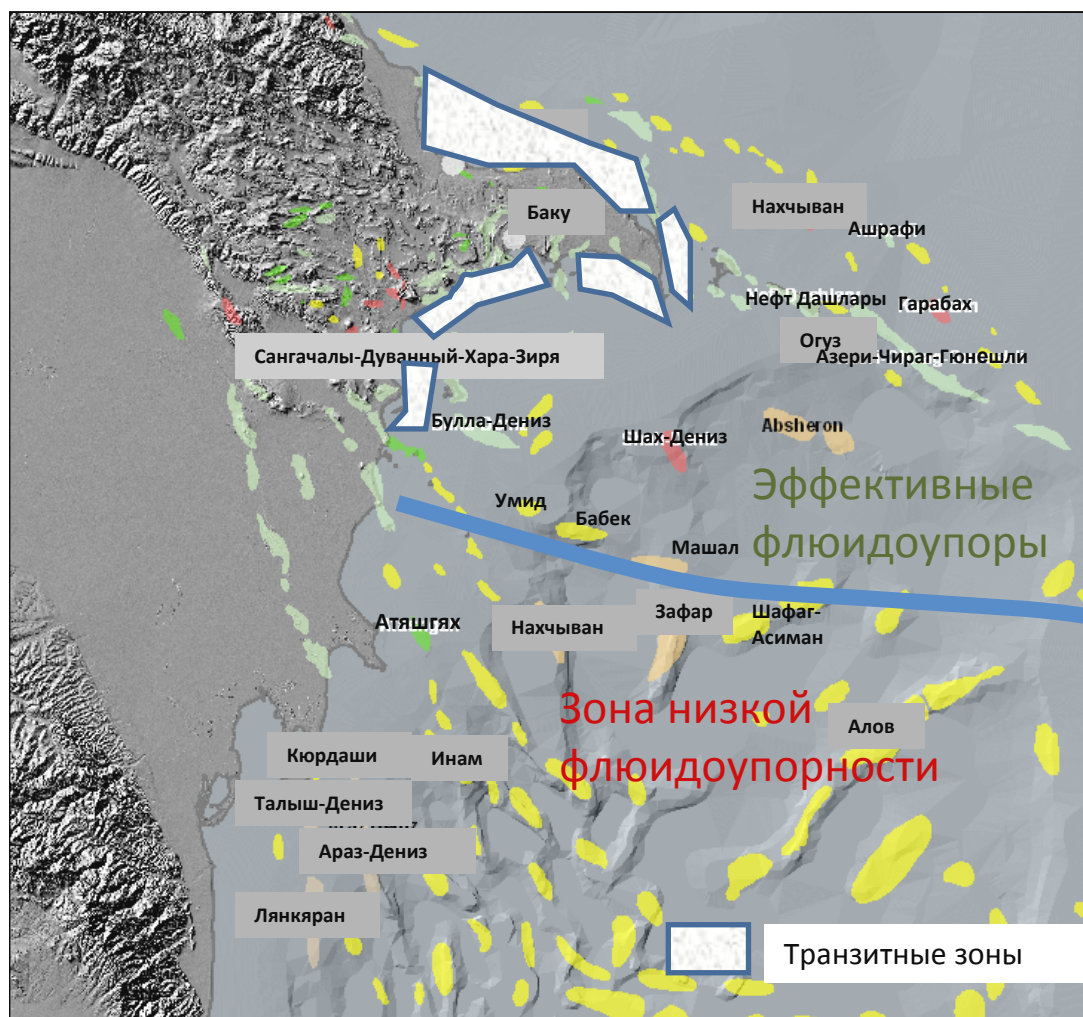
Рис.2. Карта распространения регрессии давления в резервуарах, формирующей высокую флюидоупорность в покрышках
